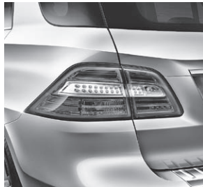
Heckleuchten in LED-Lichtleitertechnik
