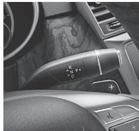
DIRECT SELECT-Schaltung mit Lenkradschalt paddles
