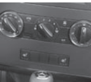
Klimaanlage und Umluftschalter
