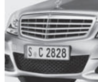
Lufteinlass mit Rautengitter
