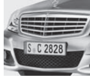
Lufteinlass mit Rautengitter
