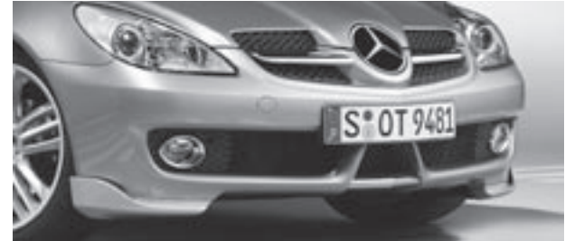
Frontschürzenspoilerlippen, Chromzierteile für Querfinnen im Kühlerstege und Stoßfänger
